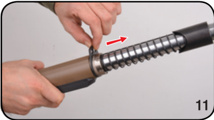
11. Remove the sling swivel nut.
